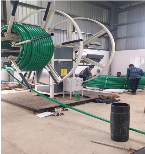
Fig-5, PLHDPE Pipe Uncoiling
