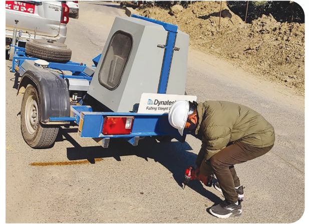
सडक विभागबाट खटिएको टोली पूर्व-पश्चिम राजमार्गको धानखोला-लमही खण्डमा फलिड वेट डिफ्लेक्टोमिटरको प्रयोग गरी सडकको डिफ्लेक्सन मापन गर्दै ।
