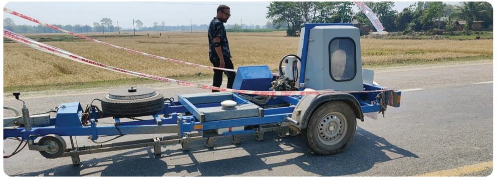
एफडब्लूडी उपकरण प्रयोग गरी सप्तरी जिल्लाको कञ्चनपुरमा २०७९ साल चैत १५ गते सडकको डिफ्लेक्सन मापन गरिँदै ।
