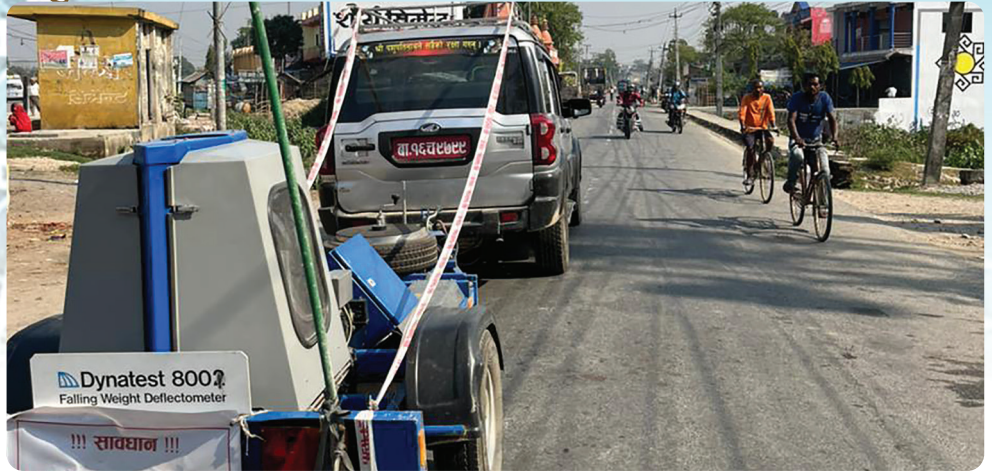
एफडब्लूडी उपकरण प्रयोग गरी सप्तरी जिल्लाको नादाहामा २०७९ साल चैत १५ गते सडकको डिफ्लेक्सन मापन गरिँदै ।
