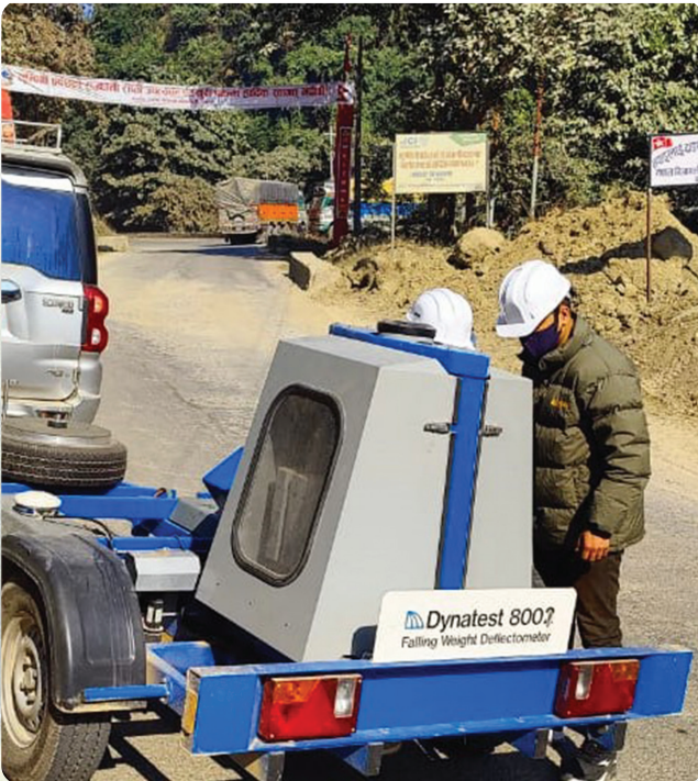
सडक विभागको टोली पूर्व-पश्चिम राजमार्गको धानखोलादेखि लमहीसम्मको सडक खण्डको पेभमेण्ट डिफ्लेक्सन मापन गर्दै ।
