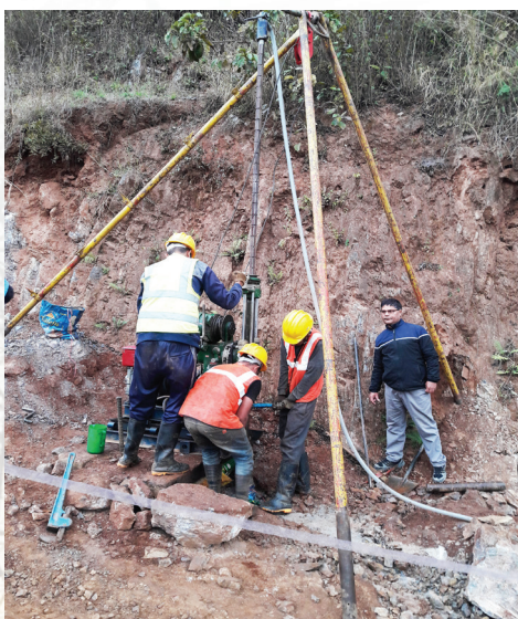
प्रसारण लाइनको टावर निर्माण गरिने क्षेत्रमा पर्ने धादिङ्ग जिल्लाको बेनिघाट-५ मा २०७५ साल फागुन १५ गते माटो परीक्षण गरिँदै ।
